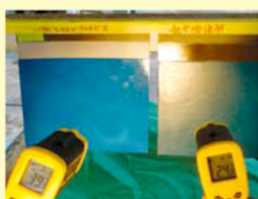
一般塗料と熱交換塗料の 違いを実際に実験しました。 結果、15℃の差がでました！
